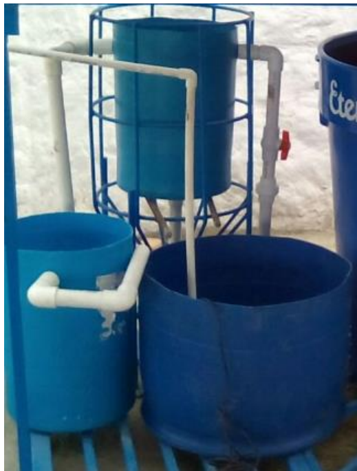
Figura 3. Tanque para filtrar el agua o Biofiltro del prototipo acuapónico.
