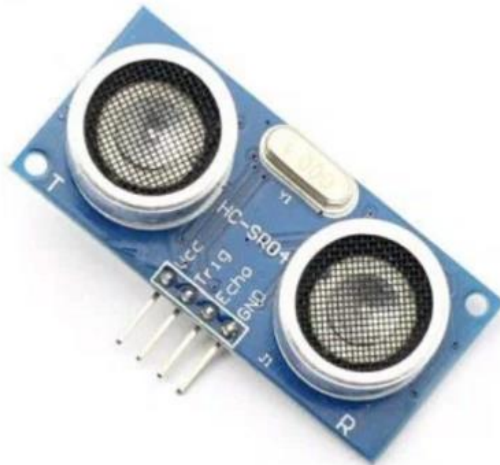
Figura 26. Sensor de distancia de ultrasonido HC-SR04
