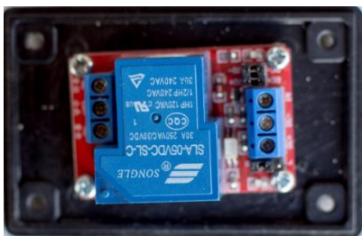
Figura 31. Módulo circuito aislante estación B
