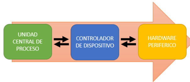
Figura 36. Interacción de los componentes de software y hardware del PLC
