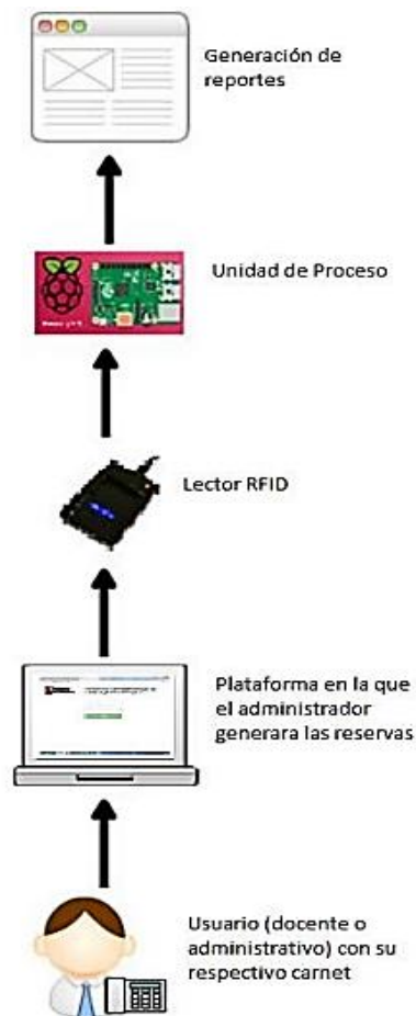
Figura 2. Sistema control de acceso a los auditorios. Fuente. Elaboración propia.
