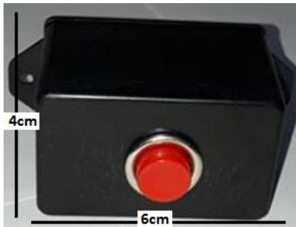
Figura 43. Botón de cantonera eléctrica. Fuente. Elaboración propia.
