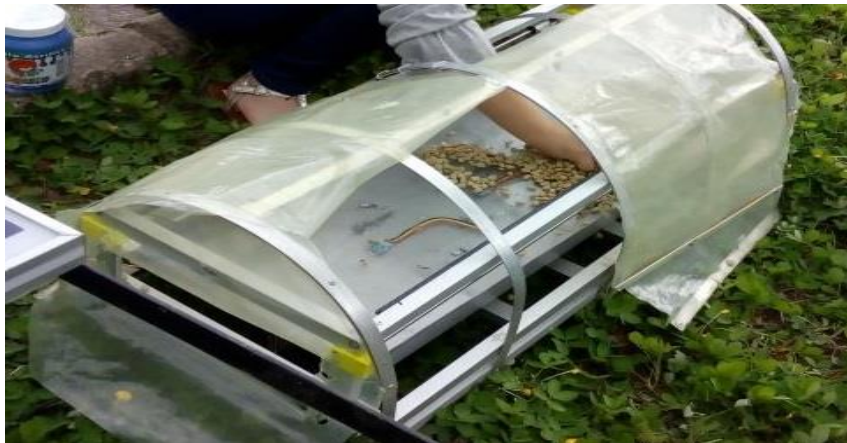
Figura 8. Estructura del Prototipo Secador Parabólico Fuente: Autor.
