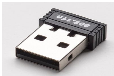
Figura 17. Módulo Wifi 802.11b. En “Módulo WiFi miniatura para Raspberry Pi” por Techmake electronics, 2018.
