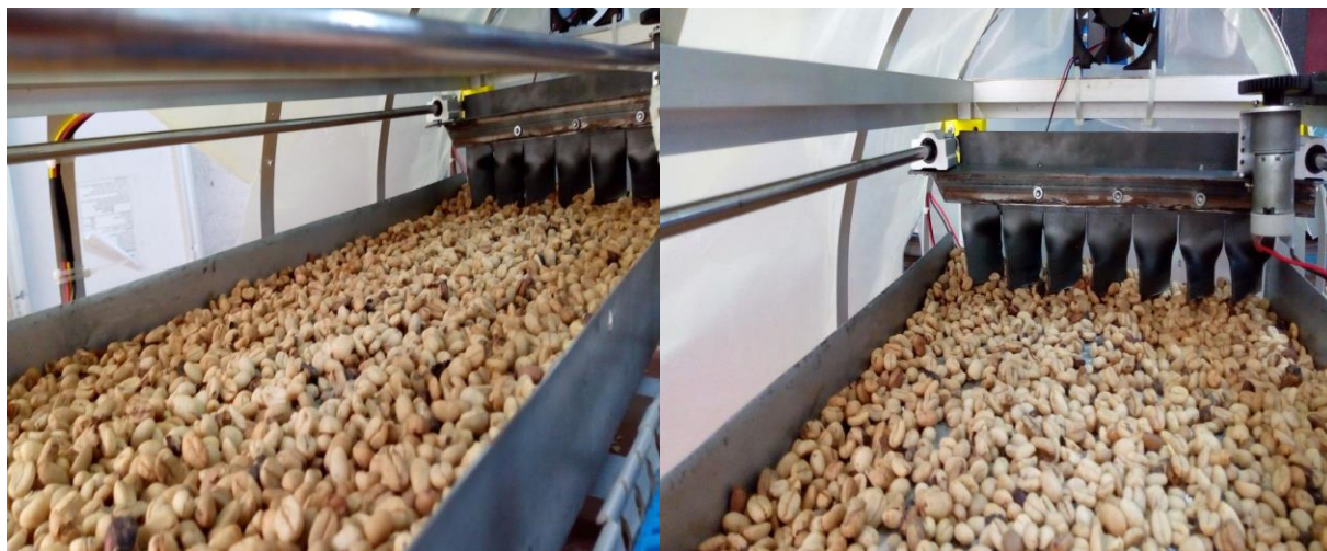
Figura 69. Segunda prueba de Sistema de Rastrillo. Fuente: Autor.
