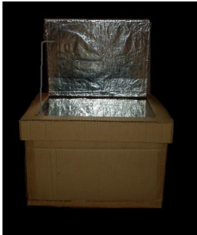
Foto 5. Terminación de la estufa solar, Grupo trabajo de grado
