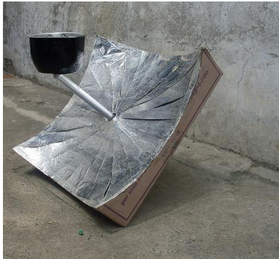
Foto 7. Estufa solar (Método Ustorio)
