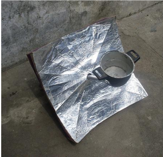
Foto 10. Comprobación de la estufa solar por el método ustorio, Grupo trabajo de grado
