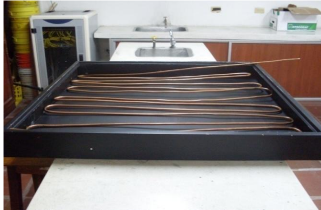
Foto 14. Construcción del colector solar de placa plana, Grupo trabajo de grado
