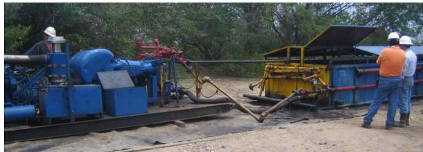
*Figura 24. Montaje para prueba manométrica*
