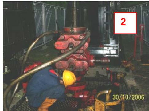
4.3.8 Instalar el elevador y las cuñas correspondientes según el diámetro de la tubería con la que se va a trabajar.
