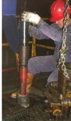
4.3.5 Bajar lentamente la tubería (Ver Procedimientos Bajada de Tubería) hasta tocar el tope del colapso.
