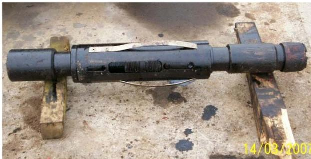
*Figura 20. Ancla (tubing anchor catcher)*
