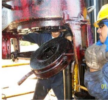
4.3.10 Estando la tubería debidamente soportada por la mesa de cuñas, se instala la llave hidráulica de tal manera que la tubería quede dentro de la misma, y el cuello del tubo quede sobre la llave a una distancia que permita la instalación del elevador.
