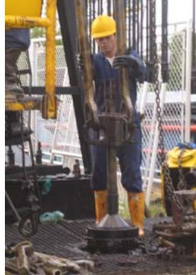
4.3.4 Levantar la sarta de tubería (figura 1), colocar la mesa de cuñas y la chancha para evitar que caigan objetos extraños al pozo, soltar el casing hanger (figura 2).
