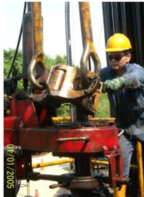
4.3.13 Levantar la sarta lentamente (mientras se abre la mesa de cuñas) hasta que quede la tubería en su peso libre. Se empieza a sacar la parada operando el equipo de tal manera que el equipo no se sienta forzado al tratar de ganar velocidad, hasta que salga el cuello del segundo tubo. Se debe tener especial cuidado al subir el primer tubo, pues en ocasiones uno de los arietes de la
