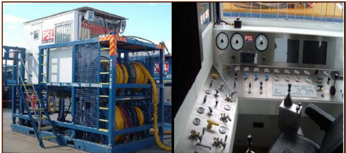
Figura 18. Unidad Primaria de Potencia (Power Pack) / Cabina de Control
