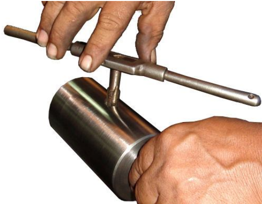
Figura 20. PROCESO DE ROSCADO EN UNO DE LOS PORTAVÁLVULAS.
