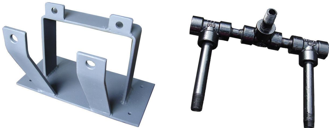
Figura 21. BASE Y MANIFOLD DEL MONTAJE EN PROCESO DE PINTURA.
