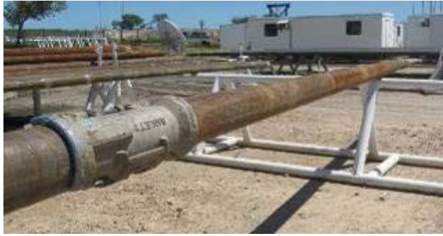
Figura 33. Martillo hidráulico de perforación (hydraulic drilling jar)
