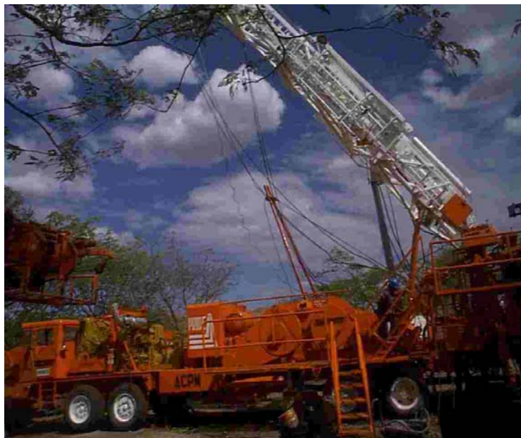
Figura 9. Izaje de la torre de un equipo de workover
