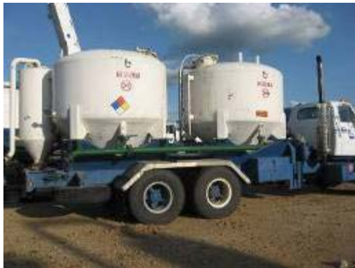
Figura 18. Tanques para cemento
