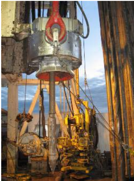
Figura 17. Spider elevator y herramienta para llenado de casing.
