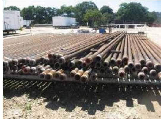
Figura 14. Tubería drill pipe en los soportes
