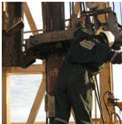
Figura 16. Operador enroscando junta de casing con llave hidráulica.
