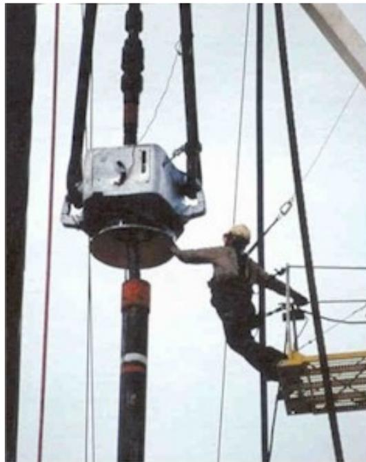
*Figura 39. Alineación de la Junta por el Encuellador.*
