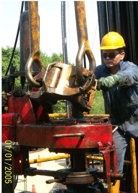
*Figura 31. Instalación del Elevador según el Diámetro a Correr.*
