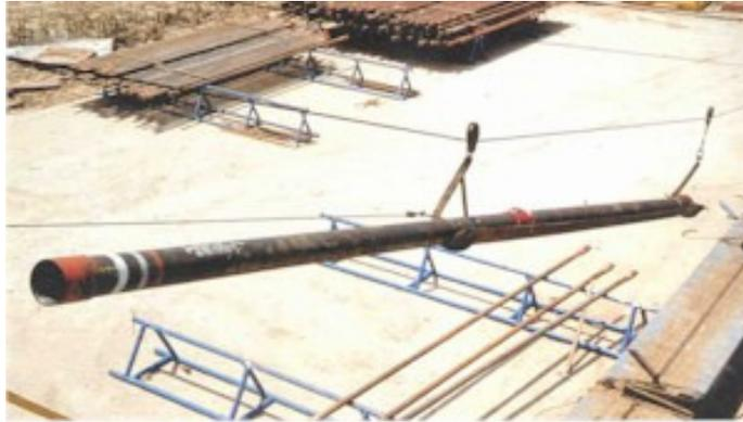
*Figura 34. Desplazamiento de la Tubería desde la Planchada hasta la Mesa.*
