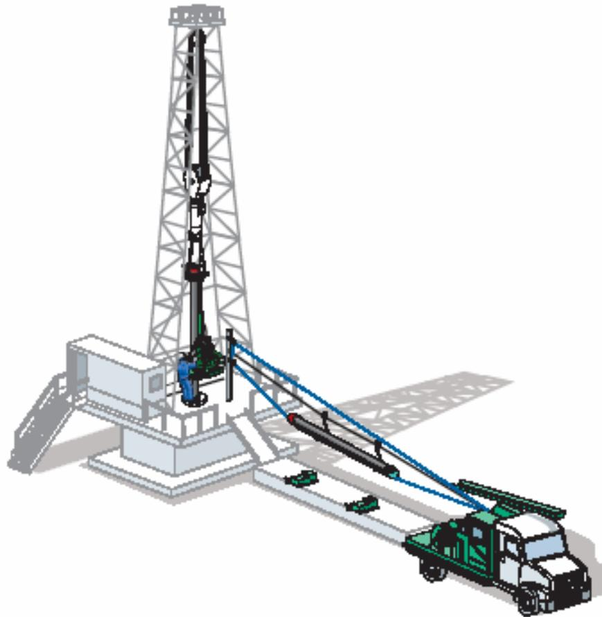
*Figura 18. Movimiento de los Tubos desde el Bancal hasta la Plataforma.*
