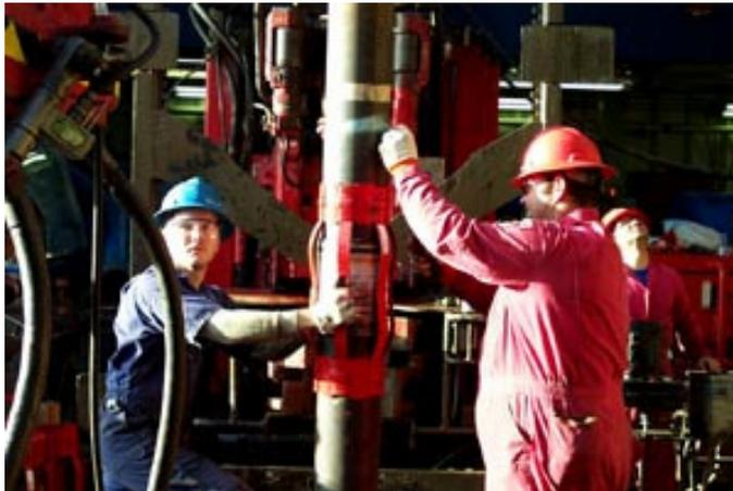
*Figura 37. Instalación del Centralizador.*
