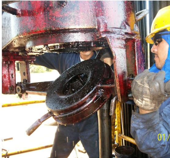
*Figura 32. Instalación de Llave Aguantadora de Diámetro Requerido.*
