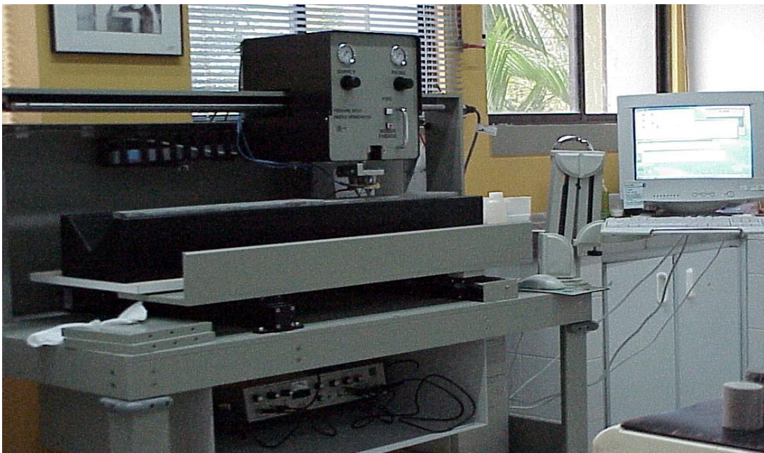
Figura 1. Equipo Pdpk-400 para la determinación de permeabilidad sonda - Cortesía ICP.
