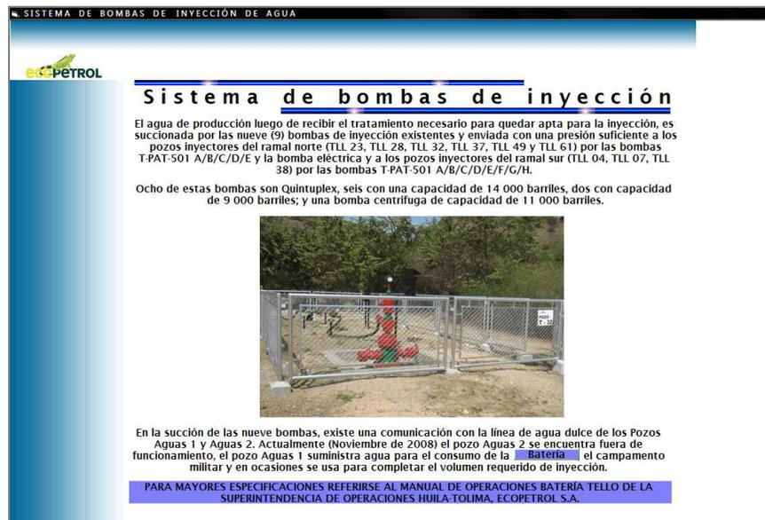
Figura 53. Sistema de bombas de inyección.
