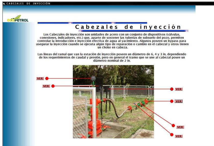
**Figura 54.** Cabezales de inyección.
