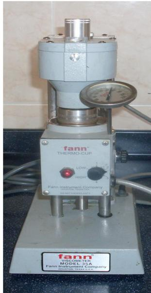
Foto 7. Viscosímetro rotatorio de cilindro concéntrico FANN 35 calibrado
