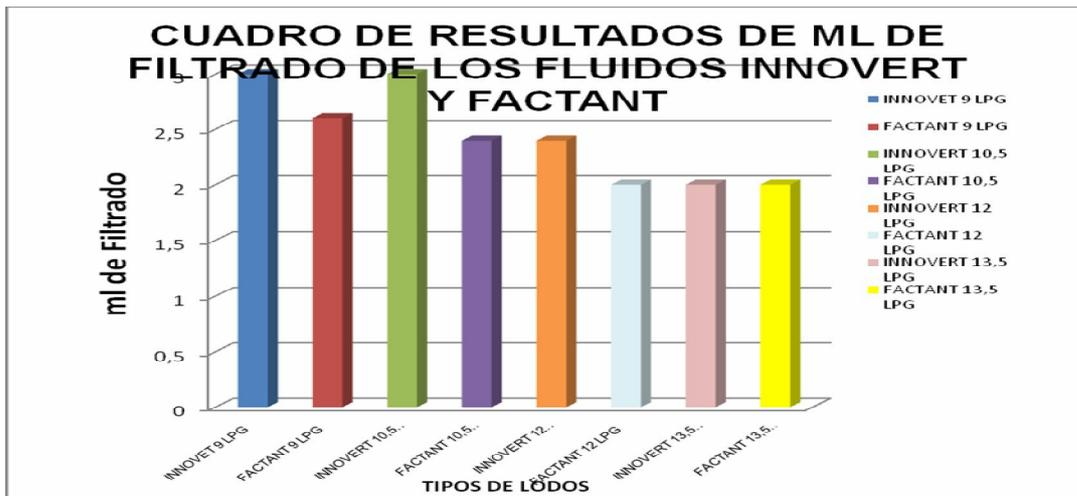
Grafico 4. Diagrama de barras de los resultados de ml de filtrado de el lodo que se obtuvo en la prueba APAT de el fluido INNOVERT Vs el FACTANT (fluido que se usaba en el Campo Cupiguá) a diferentes densidades.
