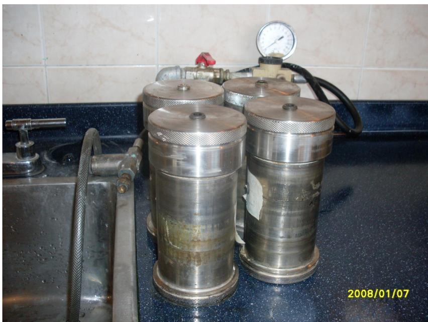
Foto 11. Celdas para el lodo de alta temperatura.
