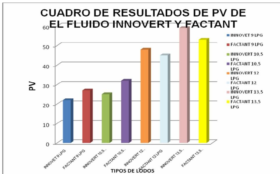
Gráfico 3. Diagrama de barras de los resultados de PV de el equipo FANN 35 de el lodo INNOVERT Vs el FACTANT (fluido que se usaba en el Campo Cupiagua) a diferentes densidades.
