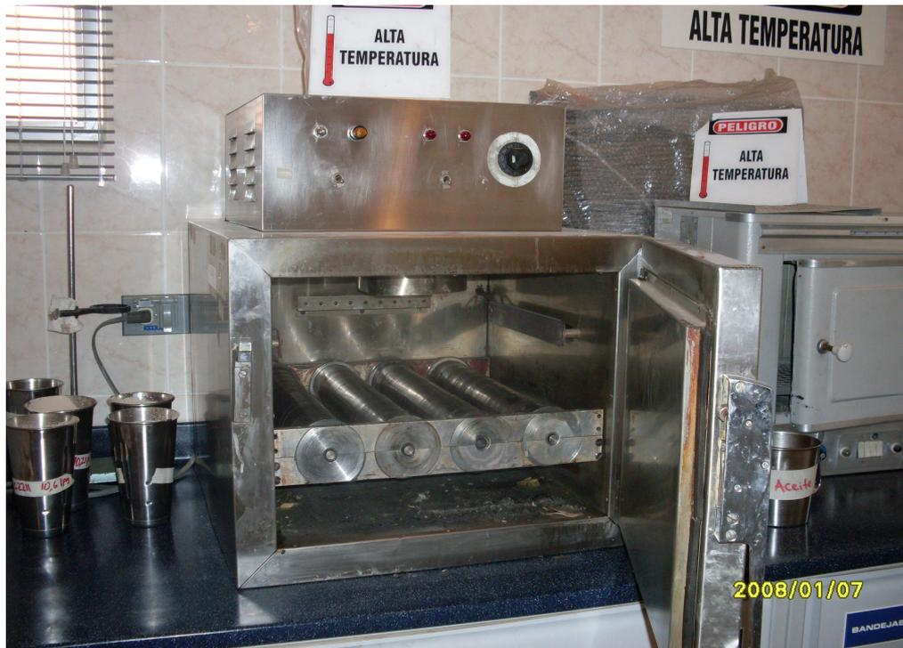
Foto 12. Horno de alta temperatura con rodillos, para simular condiciones de yacimiento
