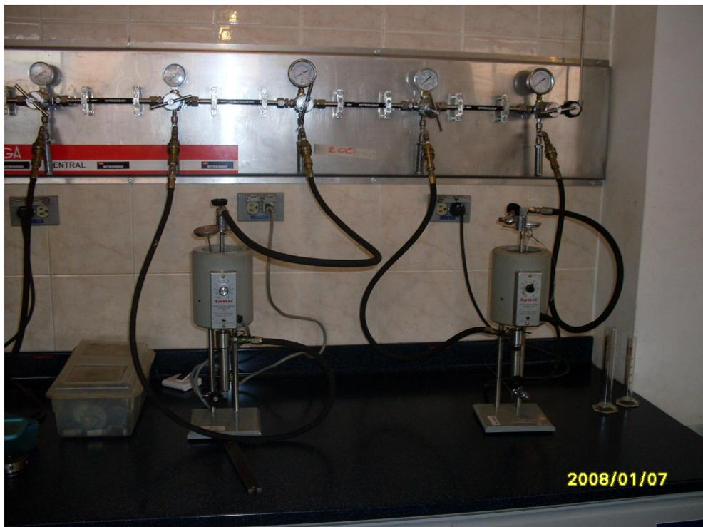
Foto 5. Filtro prensa Baroid 500 ml APAT.
