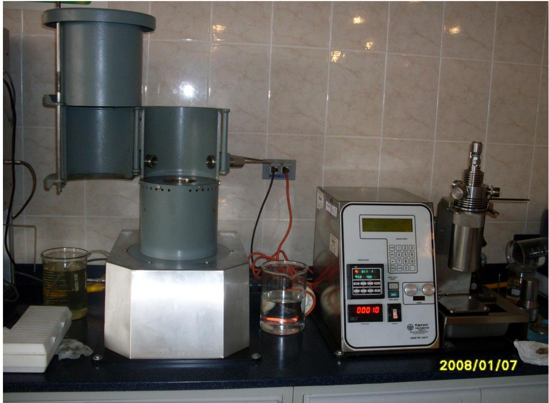
Foto 8. Viscosímetro APAT FANN 70 (alta presión y alta temperatura)
