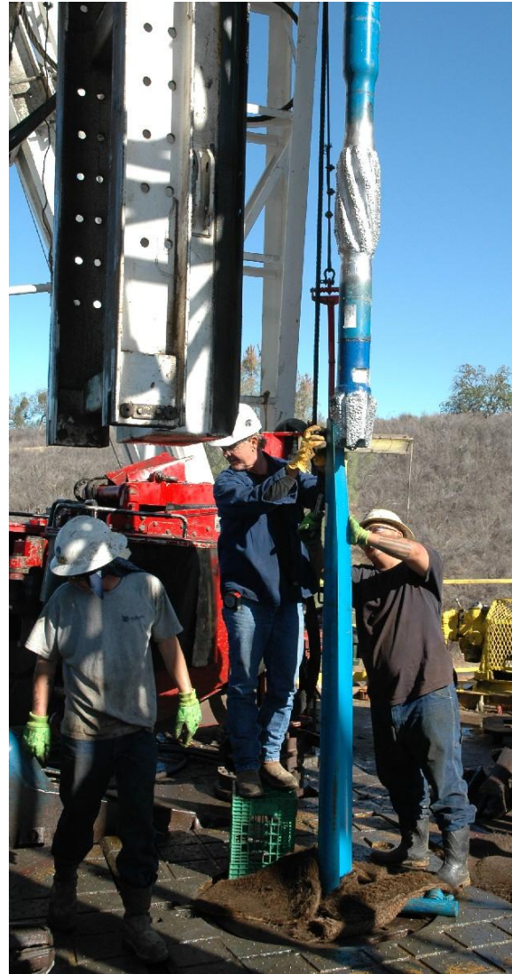
Figura 2.13 Proceso de una perforación radial. Nótese el componente de color amarillo con forma de cuña que permite desviar el trayecto del pozo en el rumbo indicado (tomado de Smith International).
