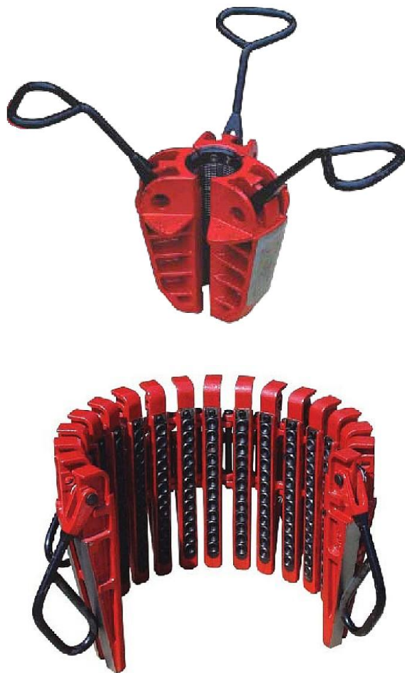
Figura 2.17. Arriba, cuña de tres cuerpos o pechugas para diámetros pequeños; abajo, cuña de muchos cuerpos para diámetros de tubería grandes. (tomado de Mud King Products)
