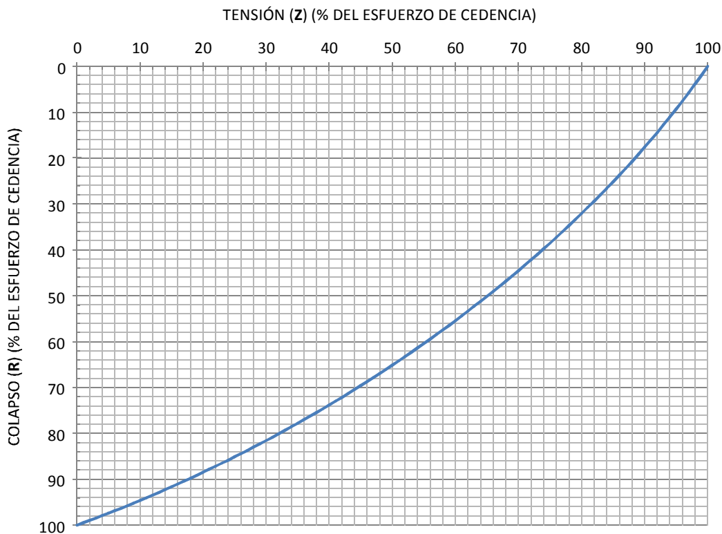
Figura 3.10 Curva para corregir resistencia al colapso de la tubería de perforación por efecto de la tensión.
