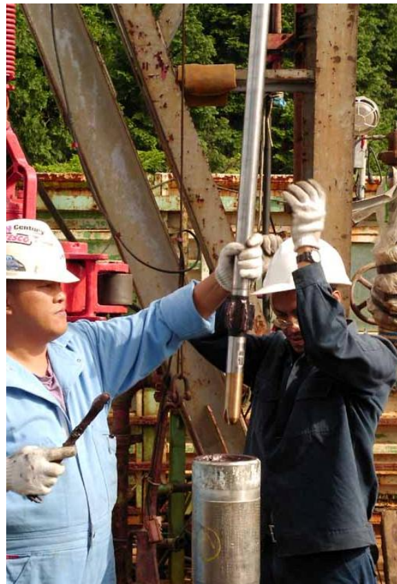
Figura 4.12. Herramienta MWD al momento de introducirse en el monel durante una bajada de tubería al pozo (tomado de hakone.u-tokio.jp).
