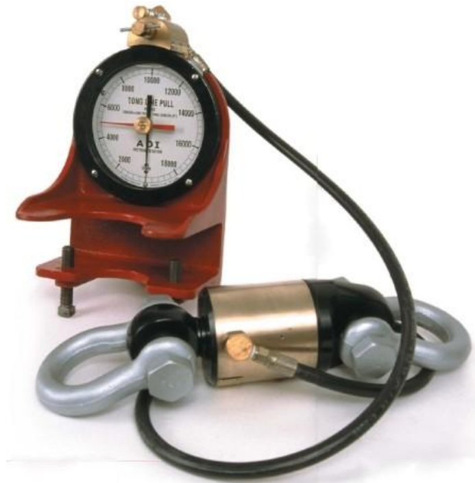
Figura 5.6 Indicador de halado e indicador de tensión. El indicador de halado posee un pistón interno que al moverse presuriza fluido hidráulico que llega al indicador de tensión a través de una manguera. Es importante aclarar que el indicador de tensión no muestra el torque sino el halado de la línea que va a la llave de potencia. (tomado de AOI Instrumentation)
