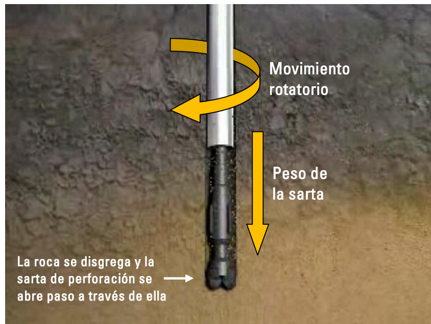
Figura 1.1. Principio básico de la perforación de pozos profundos (modificado de HorizontalDrilling.org)
