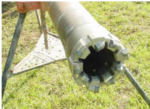
Figura 2.12 Broca para corazonamiento (tomado del Servicio Geológico de los Estados Unidos USGS).
