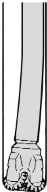
Figura 4.3 Desalineación angular de la sarta de perforación (tomado de Smith International)
