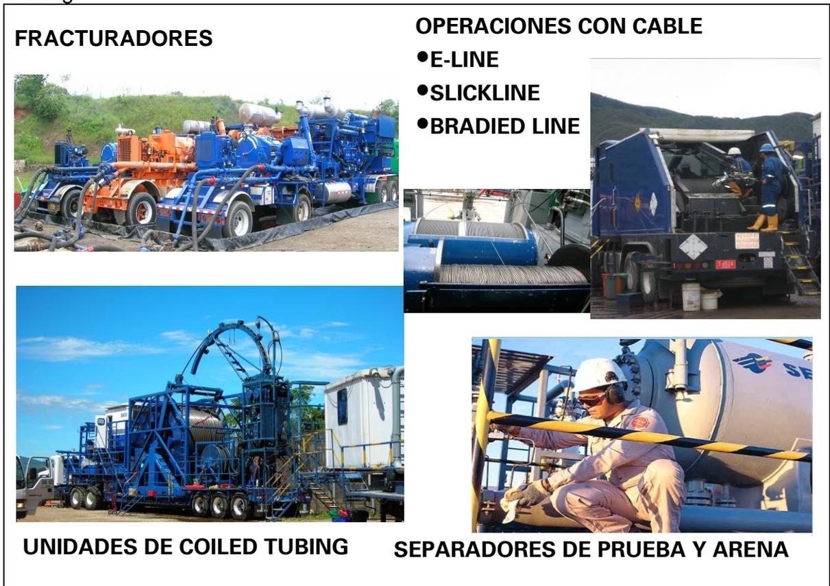
Figura 4. Equipos y unidades más frecuentes utilizadas para la operación de WIT
