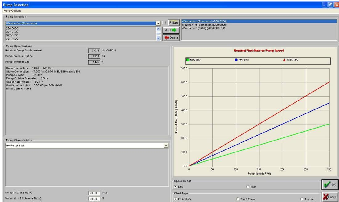
Figura 38. Catalogo del software PC-PUMP™ para la selección de bombas
