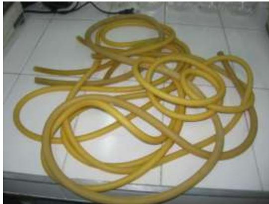
*Figura 47. Foto de mangueras térmicas para realizar montajes de pruebas de viscosidad a diferentes temperaturas.*
