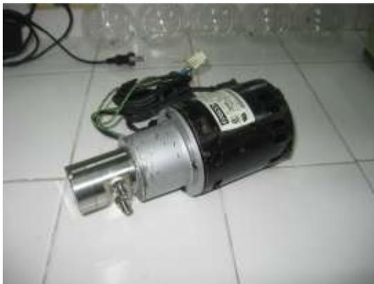
*Figura 48. Foto de una bomba de desplazamiento de fluidos, necesaria para hacer circular el fluido a través de la chaqueta térmica.*
