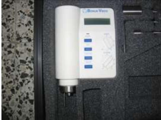
*Figura 36. Foto del viscosímetro Bohlin Visco 88.*
