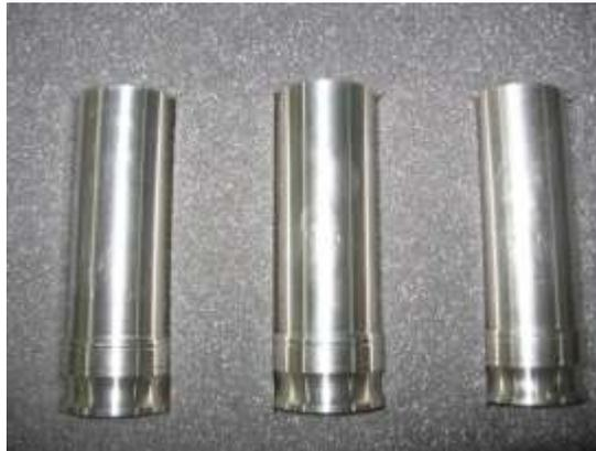
*Figura 43. Foto de las copas especiales que se deben usar con la chaqueta térmica del viscosímetro Bohlin Visco 88.*
