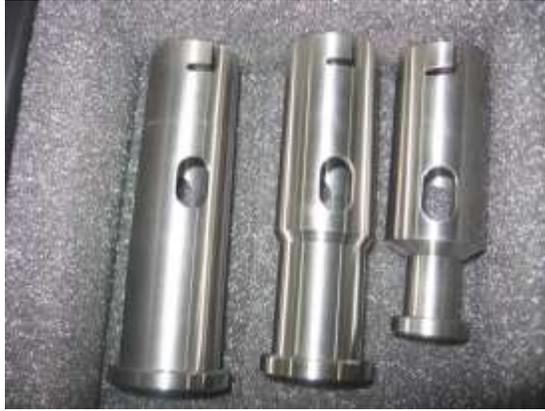
*Figura 40. Foto de las copas tipo DIN estándar que posee el viscosímetro Bohlin Visco 88.*
