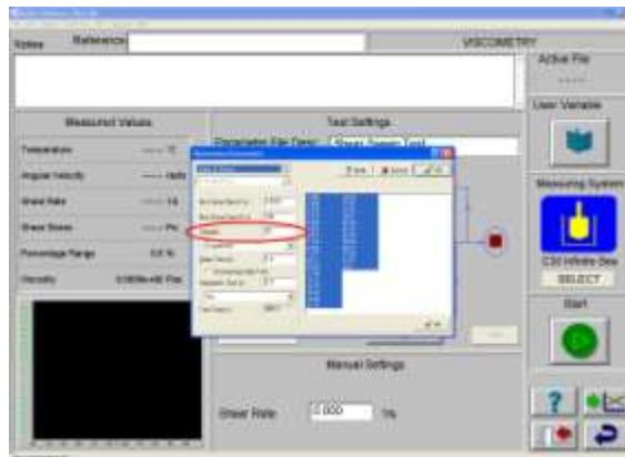
Figura 109. Imagen capturada de la interfaz “viscometry parameters” del software “Bohlin R6.50.5.7.” señalando el cuadro de texto “samples”.
