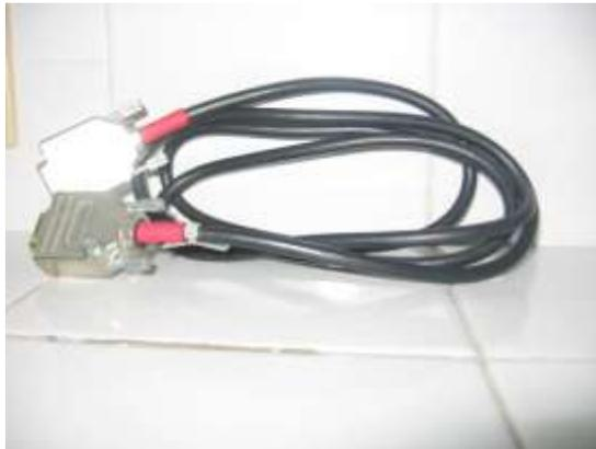
*Figura 39. Foto del cable RS-232 para controlar el viscosímetro por medio de un computador.*
