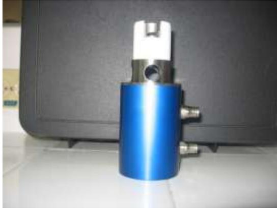
*Figura 42. Foto de la chaqueta térmica que incluye circulador manual, del viscosímetro Bohlin Visco 88.*
