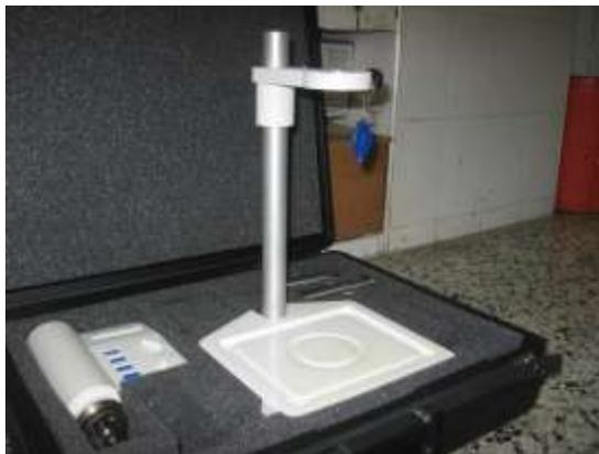
*Figura 37. Foto del soporte del viscosímetro Bohlin Visco 88.*
