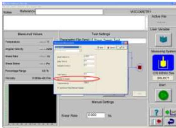
Figura 95. Imagen capturada de la interfaz “viscometry parameters” del software Bohlin R6.50.5.7 indicando el cuadro de texto “number of samples”.
