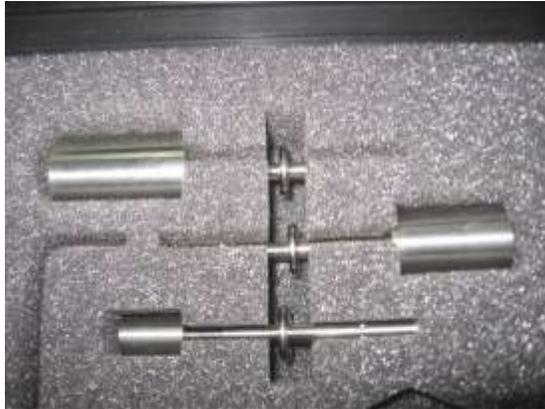
*Figura 41. Foto de los rotores tipo DIN estándar que posee el viscosímetro Bohlin Visco 88.*
