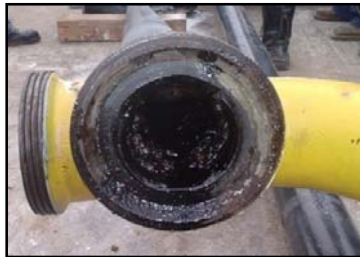
Fotografía 1. Incrustación en la línea de salida de crudo del cabezal de pozo Gigante 1A
