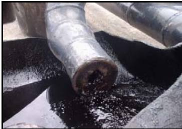
Fotografía 1. Incrustación en la línea de salida de crudo del cabezal de pozo Gigante 1A
