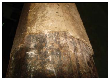
Fotografía 3. Motores de ESP recubiertos con depósitos de carbonatos
