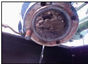
Fotografía 2. Incrustación en la válvula de la línea de salida de agua del separador
