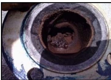
Fotografía 2. Incrustación en la válvula de la línea de salida de agua del separador
