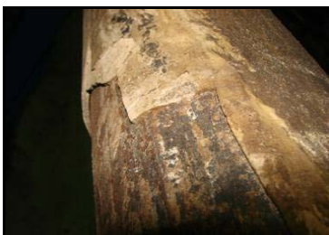
Fotografía 3. Motores de ESP recubiertos con depósitos de carbonatos
