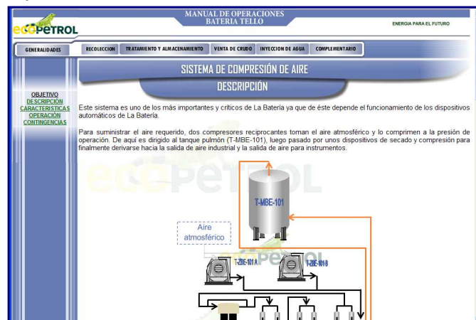
Figura 49. Ventana de descripción sistema de compresión de aire del menú de tratamiento y almacenamiento
