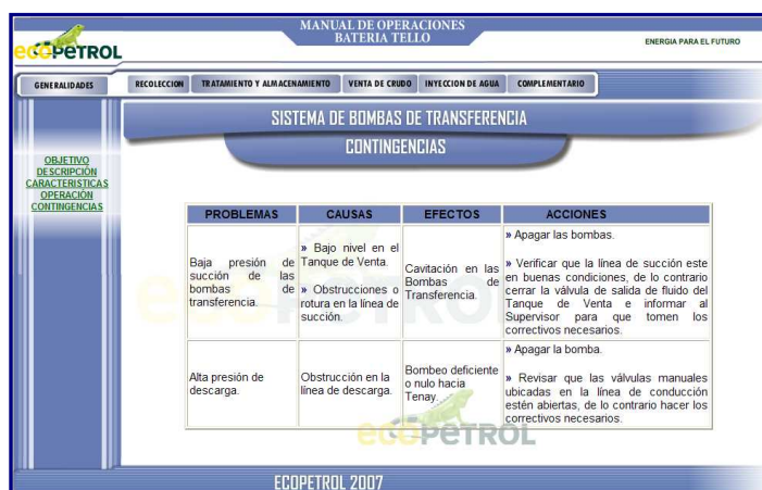
Figura 76. Ventana de contingencias del sistema de bombas de transferencia del menú de venta de crudo
