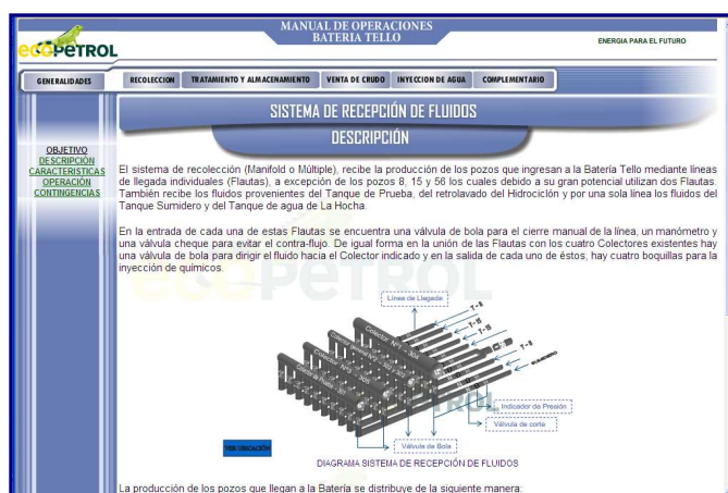
Figura 16. Ventana de descripción del sistema de recepción de fluidos del menú de recolección
