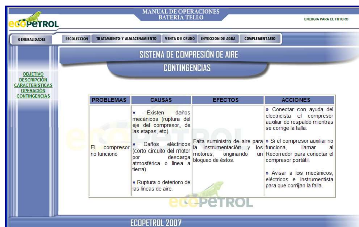
Figura 52. Ventana de contingencias del sistema de compresión de aire del menú de tratamiento y almacenamiento
