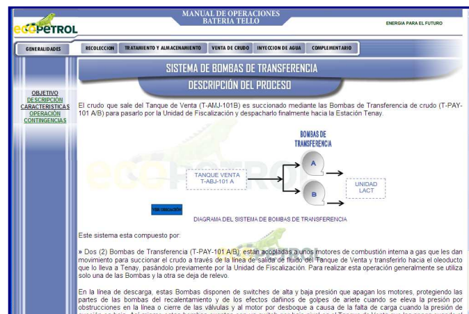
Figura 73. Ventana de descripción del sistema de bombas de transferencia del menú de venta de crudo
