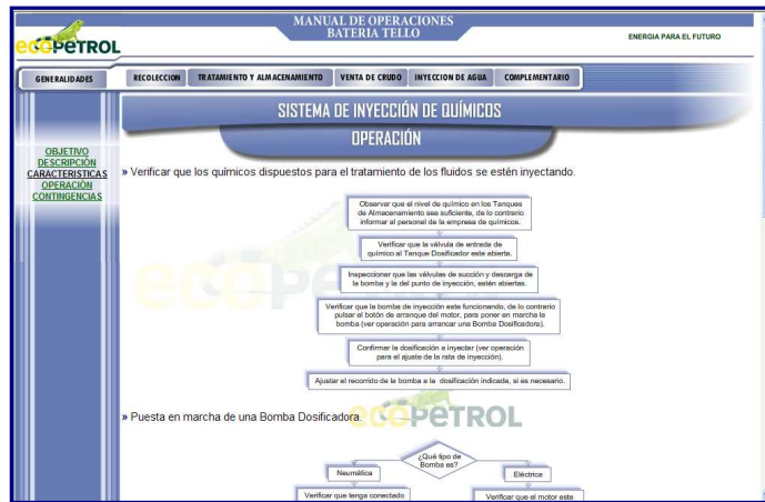
Figura 23. Ventana de operación del sistema de inyección de químicos del menú de tratamiento y almacenamiento
