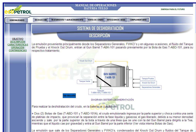
Figura 34. Ventana de descripción del sistema de deshidratación del menú de tratamiento y almacenamiento
