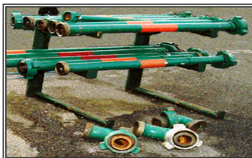
Figura 1. Líneas de superficie y codos
