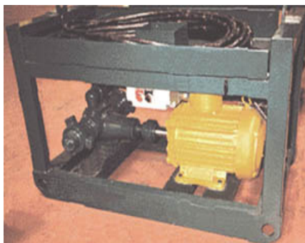
Figura 13. Bomba de transferencia
