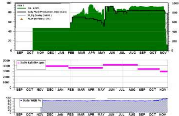
Grafico 4.8 Historial productivo, de salinidad y corte de agua del pozo C-2153. Tomado de DSS 2008.
