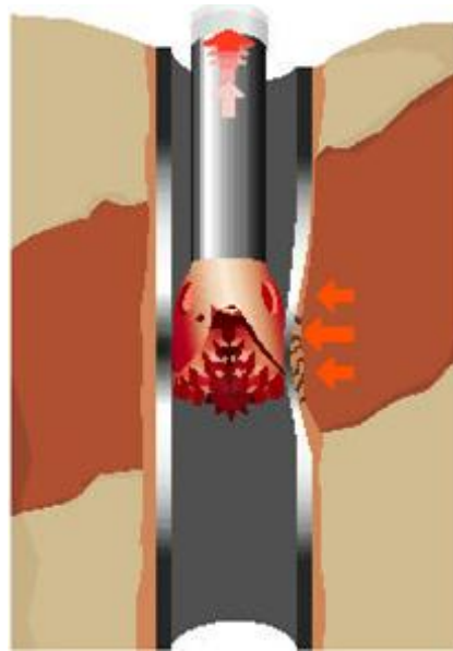
Figura 7. Revestimiento colapsado durante la perforación.
