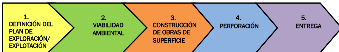
Figura No. 1: Etapas del proceso de Perforación
