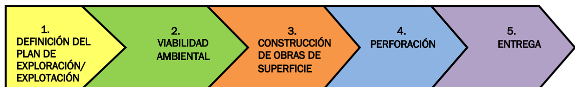
Figura No. 4: Etapas del proceso de Perforación.
