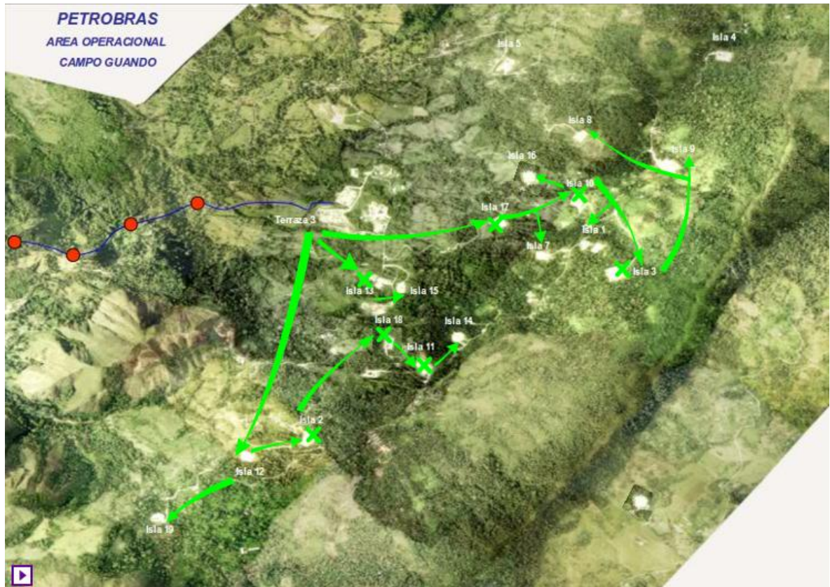
Figura 13. Distribución de Troncales hacia Pozos Inyectoros
