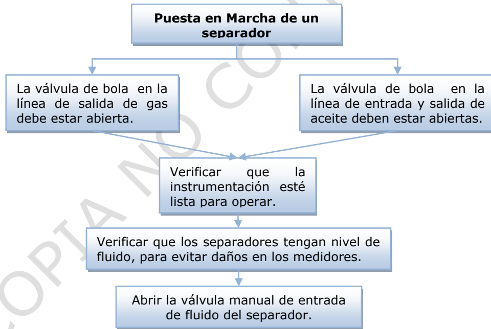
Figura 25. Procedimiento para poner en funcionamiento un separador
