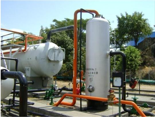
Figura 7a. Separador Bifásico vertical
