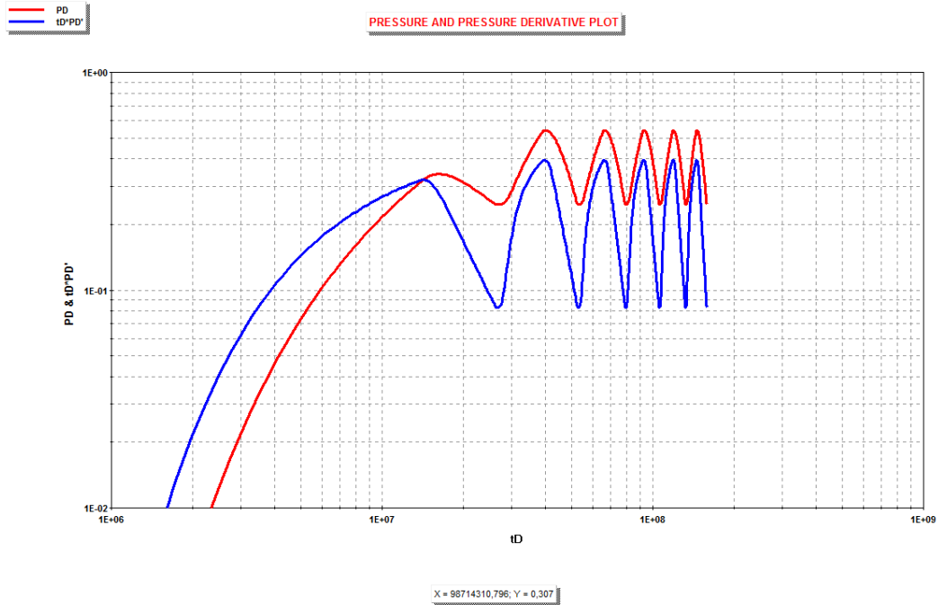
Figura 3.2. P_D, t_D * P_D' para r_e = 2500 y t_f / t_c = 1 (Exportada del Pulse Design).
