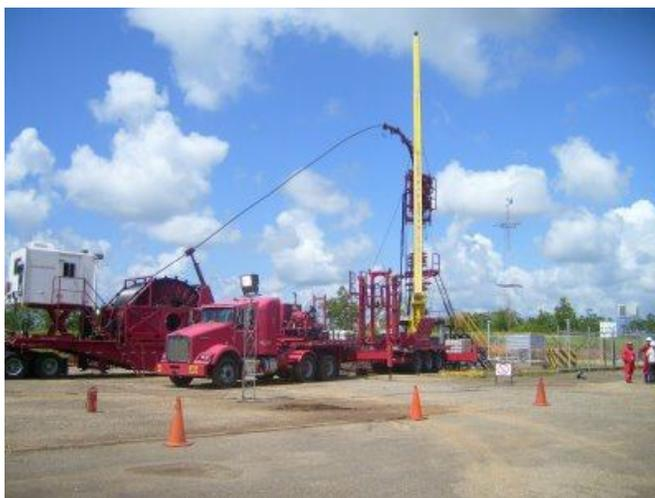
*Ilustración 5. Unidad de "Coiled Tubing" inyectando tratamiento de estimulación en fondo*
