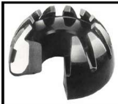
FIGURA 20. Corte de un elemento sellante anular
