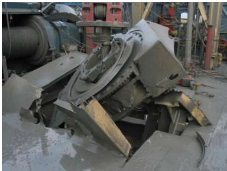
FIGURA 3. Fotografía de daño en la mesa de trabajo y derrame de lodo causado por arremetida
