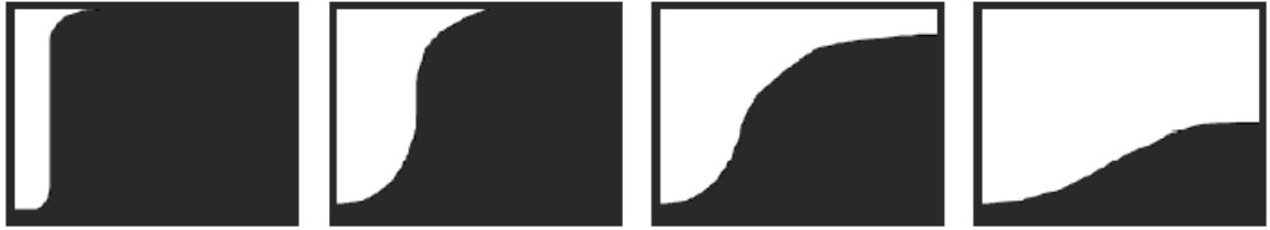
Figura 6. Crecimiento de la cámara de solvente, los progresos del tiempo de izquierda a derecha (Butler & Mokrys 1989)
