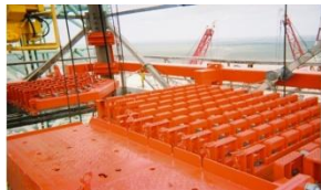
Figura 18. Sistema de Pines Separadores de Tubería
