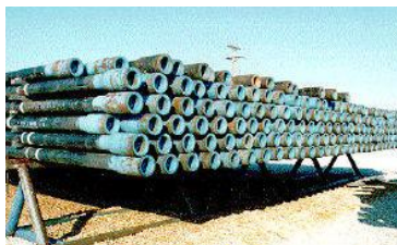
Figura 110. Soportes para almacenamiento de tubería
