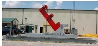
Figura 13. Operación de izaje de las BOP'S
