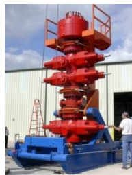
Figura 11. Montaje del Sistema de las BOP'S"
