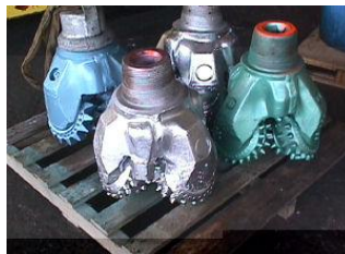
Figura 122. Brocas de perforación
