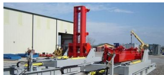
Figura 14. Sistema de Manipulación de las BOP'S
