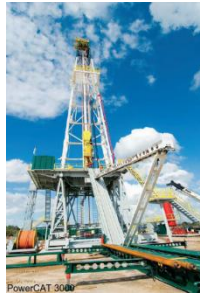
Figura 34. Equipo de perforación Power Cat 3000
