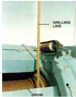
Figura 90. Línea de perforación
