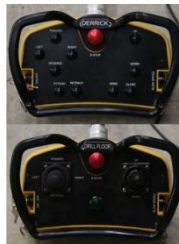
Figura 16. Sistema de Control Para Manejo de Tubería
