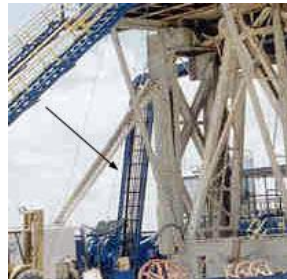
Figura 99. Plataforma para el cable 133 eléctrico
