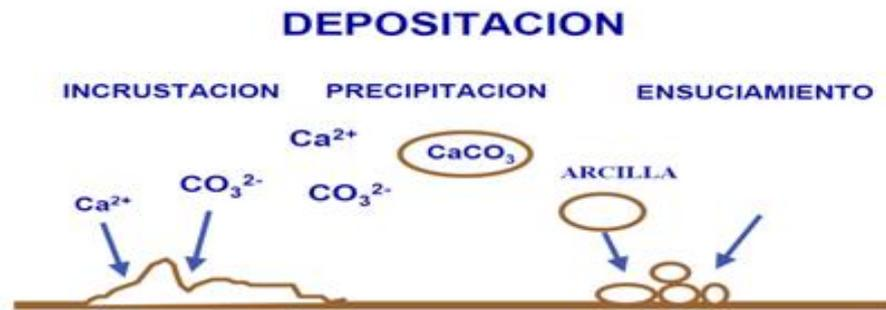
**Figura 2.2.** Esquema de formación de incrustaciones.
