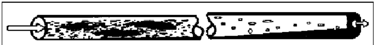
Aspectos generales del daño de formación por deposición de asfaltenos en yacimientos de petróleo
