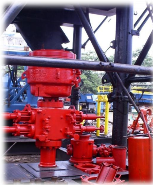
Figura 1.42 Conjunto de Preventoras (BOP's) (Imagen modificada " www.sunda.com/handling-tools )
