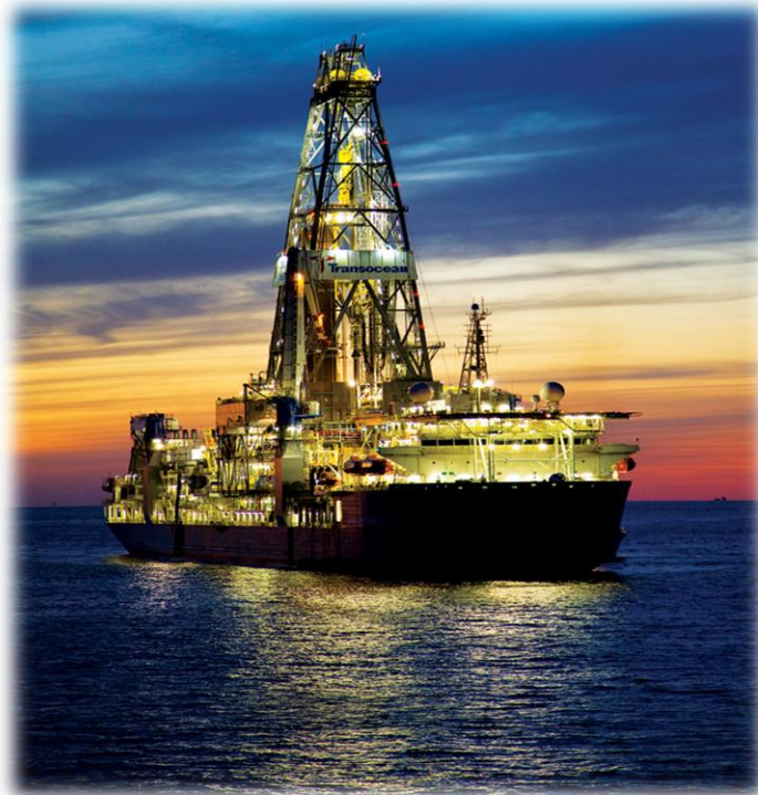
Figura 1.5 Barco de perforación (Imagen modificada "Energíadebate.com/describiendo-el-golfo-de-Mexico)
