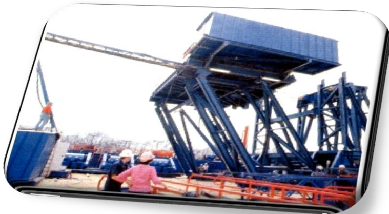
Figura 1.10 Subestructura Slingshot Desdoblada (Imagen modificada, libro “Perforación de pozos petroleros”, Capítulo III).
