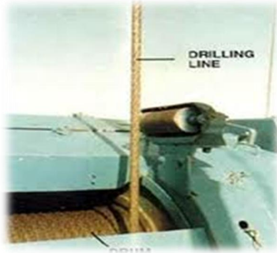
Figura 2.1 Línea del malacate (modificada de nuevosperforadores.blogspot.com).
