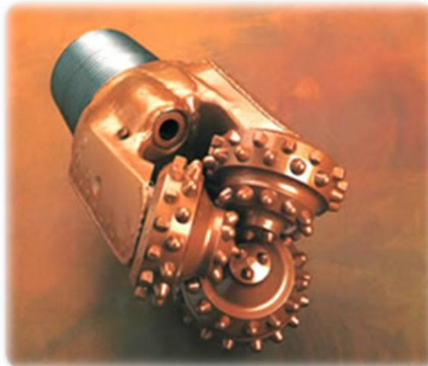
Figura 1.26 Broca tricónica (Imagen modificada, libro "Perforación de pozos petroleros", Capítulo III).
