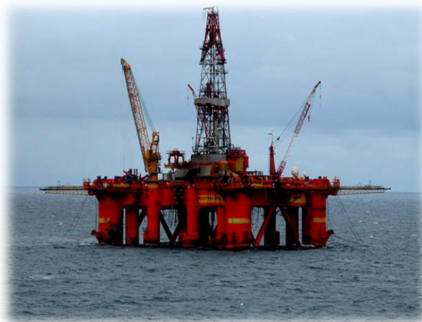
Figura 1.4. Equipo de perforación semi-sumergible (Imagen modificada, libro “Perforación de pozos petroleros”, Capítulo III).
