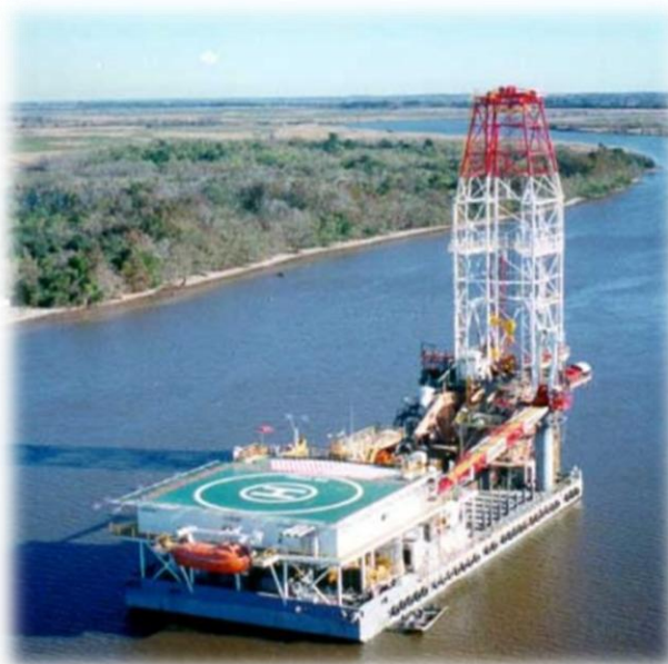
Figura 1.7 Equipo sumergible y Barcaza (Imagen modificada, libro “Perforación de pozos petroleros”, Capítulo III).
