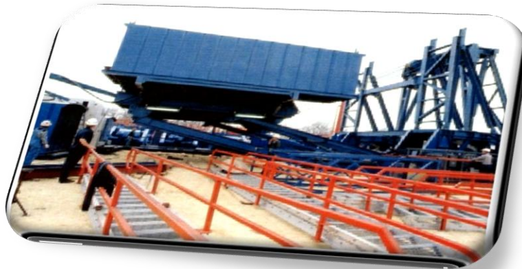
Figura 1.10 Subestructura Slingshot Desdoblada (Imagen modificada, libro “Perforación de pozos petroleros”, Capítulo III).
