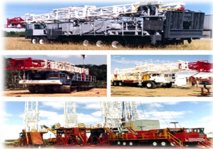
Figura 1.3 Equipo de perforación auto-transportable (Imagen modificada, libro “Perforación de pozos petroleros”, Capítulo III).
