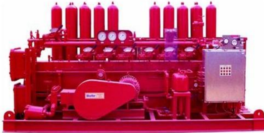
Figura 2.4 Unidad de cierre de acumuladores (modificada de Manual para Well Control, Wish Master).
