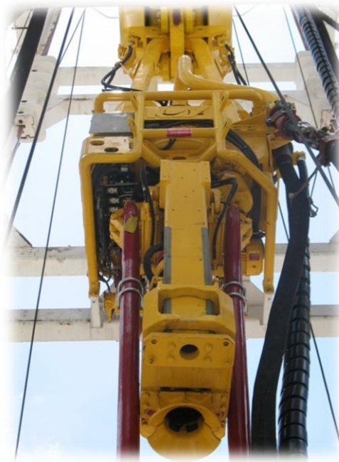
Figura 1.29 Motor Elevable (Top Drive) (Imagen modificada, libro “Perforación de pozos petroleros”, Capítulo III).
