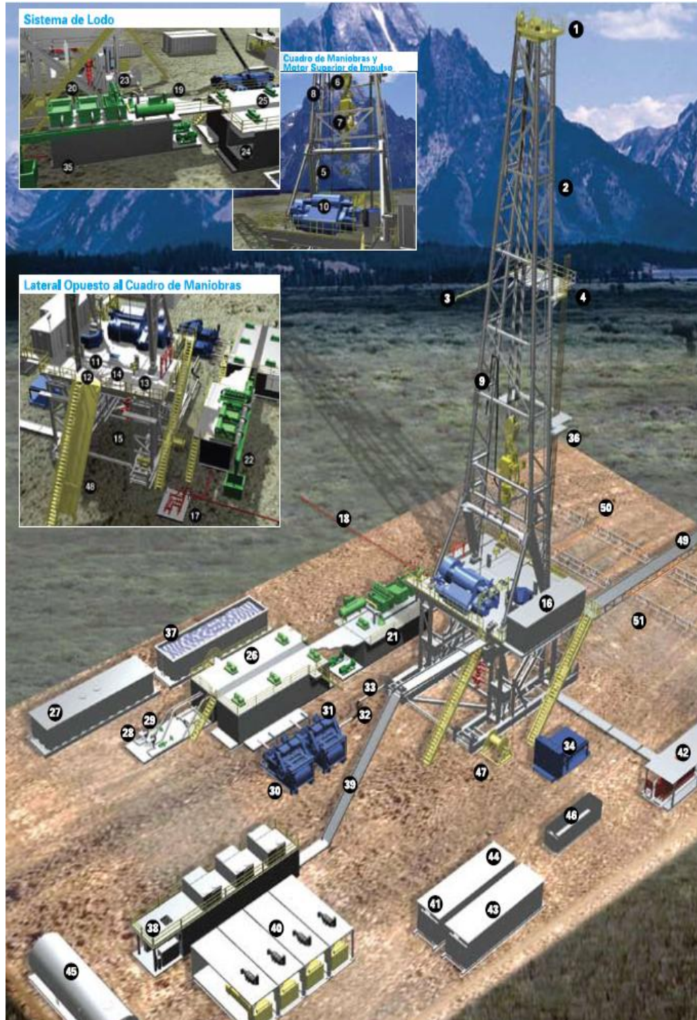
Figura 1.8 Equipo moderno para la perforación de pozos profundo (imagen modificada, libro "perforación de pozos petroleros", capítulo III).
