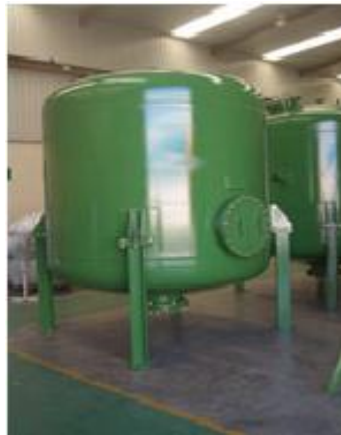
Figura 14. Filtrador de lecho filtrante 15
