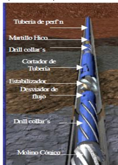
Figura 3. Diseño de sarta típica para una apertura de una ventana.
