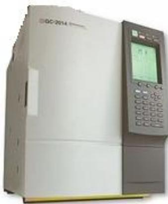
*Figura. 9. Cromatógrafo de Gas modelo GC-2014*
