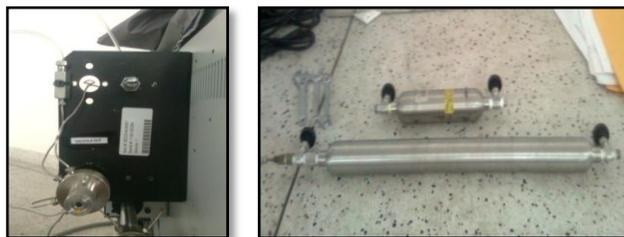
*Figura. 10. Válvula para GLP (izquierda) y cilindros para muestras (derecha).*
