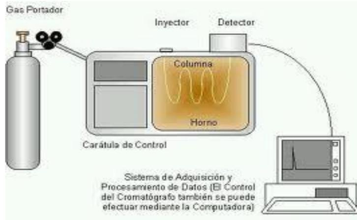
contener la longitud apropiada de fase estacionaria, mantener la columna a la temperatura apropiada (o la secuencia del programa de temperatura), detectar los componentes de la muestra conforme eluyen de la columna, y proveer una señal legible proporcional en magnitud a la cantidad de cada componente.
