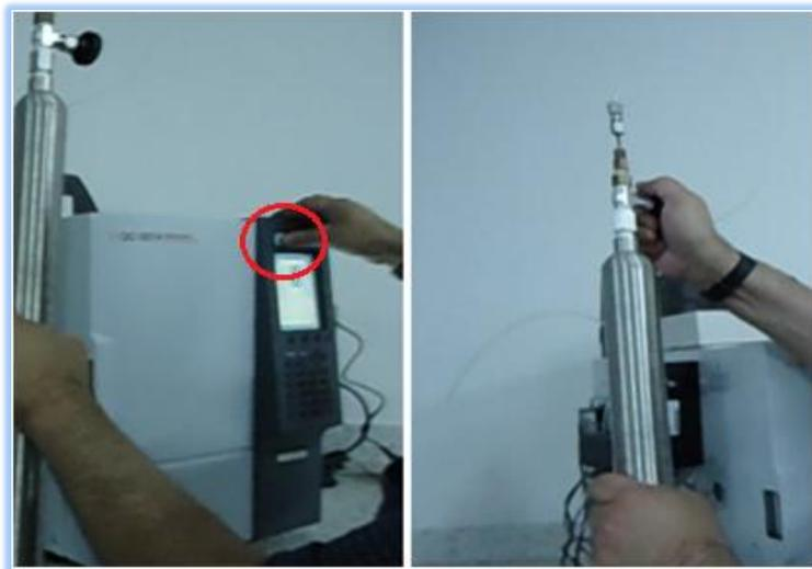
**Foto 3.** Oprimir **START**, el botón de color verde del cromatógrafo y se procede a cerrar la válvula del cilindro.
