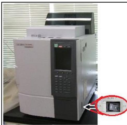
**Figura. 11.** CG, la flecha indica la posición del interruptor.
