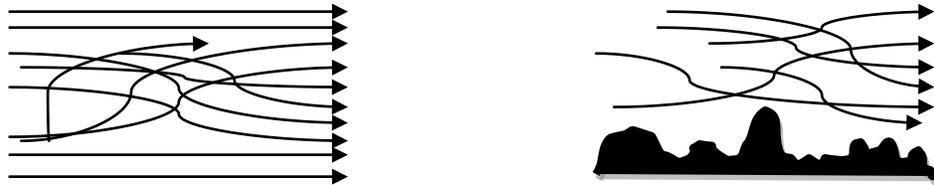
**Figura 5.** Flujo parcialmente turbulento **Figura 6.** Flujo totalmente turbulento
