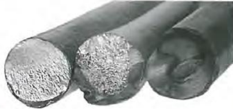
Figura 15. Ejemplos de fallas por flexión.
