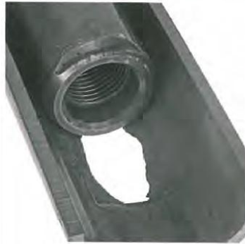
Figura 13. Ejemplo de golpe del acople contra el tubo.
