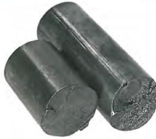
Figura 22. Fallas en barras pulidas.
