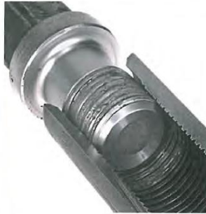
Figura 19. Desgaste de la rosca por rozamiento.
