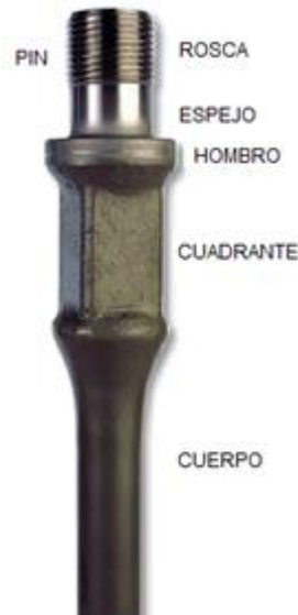
Figura 10. Partes de la varilla convencional.
