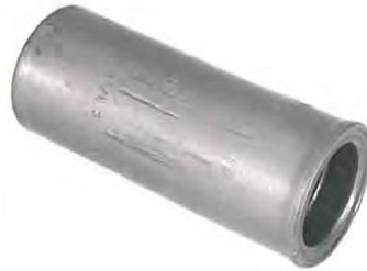
Figura 20. Falla de conexión por apriete excesivo en el acople.
