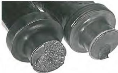
Figura 18. Ejemplos de fallas de la unión macho inducida por las llaves hidráulicas.
