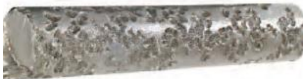
Figura 26. Ejemplo de componente afectado por corrosión ácida.
