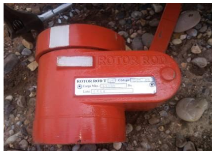
Figura 53. Ejemplo de placa de especificaciones. Correcta ubicación para instalación en la varilla.
