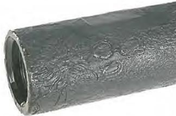
Figura 21. Ejemplo de falla de fatiga por impacto en acoples.
