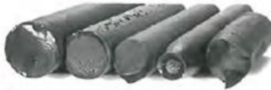
Figura 14. Ejemplos de fallas por tensión y fatiga.
