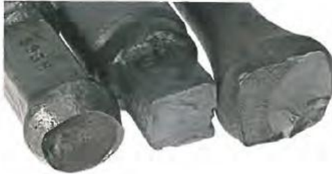
Figura 33. Ejemplo de fallas por defectos de forjado.
