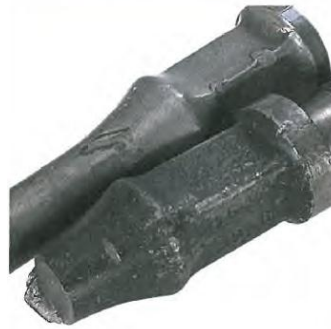
Figura 24. Ejemplo de daño superficial generado por elevadores de varilla.
