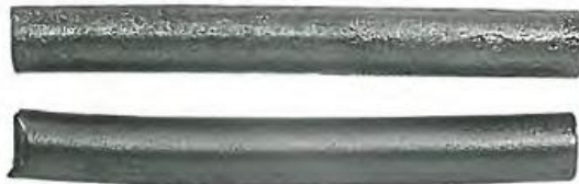
Figura 16. Ejemplos de fallas por flexión.
