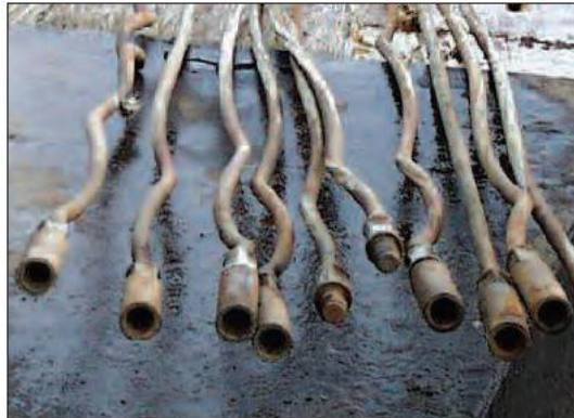
Figura 25. Ejemplo de varillas dobladas por elevador en malas condiciones.
