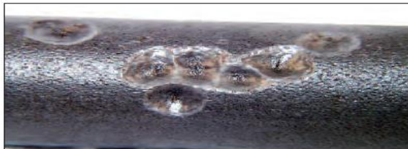
Figura 31. Ejemplo de componente afectado por bacterias reductoras de sulfato.
