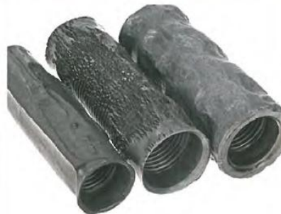
Figura 29. Ejemplos de acoples afectados por corrosión intensificada por \text{O}_2 .
