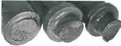
Figura 17. Ejemplo de fallas de unión macho por conexión.
