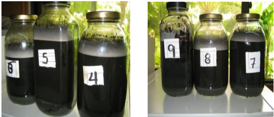
Figura 12. Prueba de botellas: arena más solución de lavado.
