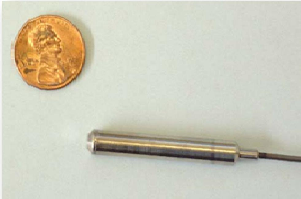
**FIGURA 3.4.** Sensor Herméticamente Sellado.
