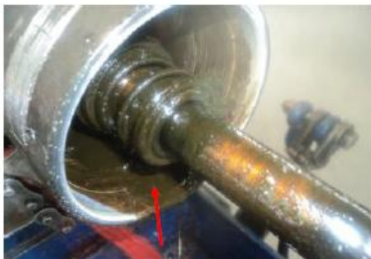
Todas las cámaras contaminadas con fluidos de pozo
