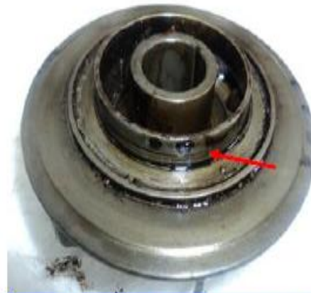
Desgaste leve en faldón y zonas de down-thrust de impulsores
