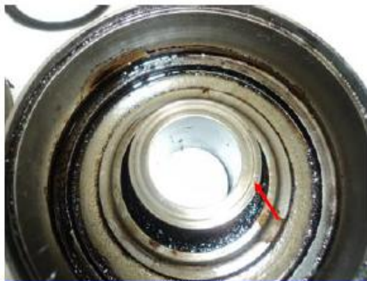
Desgastes moderados en pads de down-thrust de difusores
