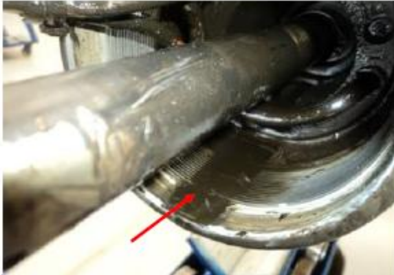
Aceite contaminado al interior del motor
