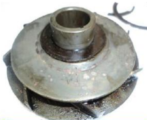
Zonas de up-thrust de impulsores en buenas condiciones
