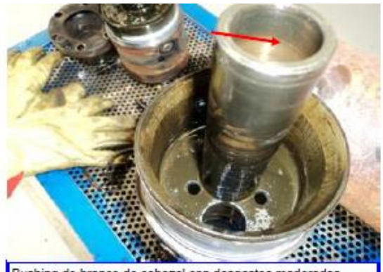
Bushing de bronce de cabezal con desgastes moderados
