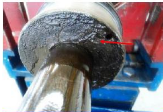
Sólidos de pozo adheridos a guías superior y central
