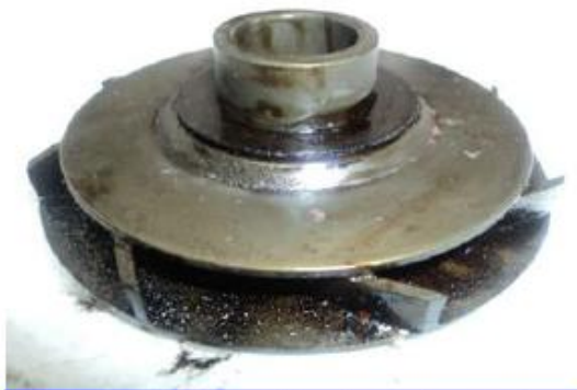
Álabes y zonas de up-thrust de impulsores en buen estado
