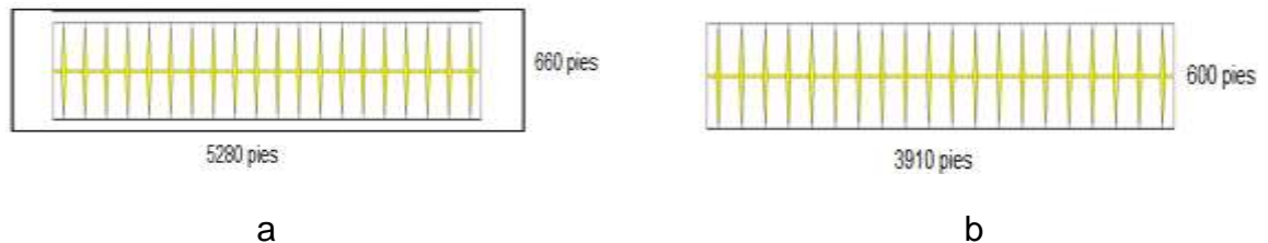
Figura 3.55 Esquemas que indican el área total (a) y estimulada (b) del pozo.
