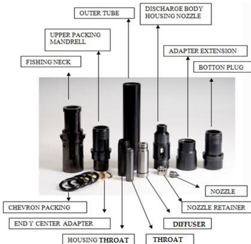
**Figura N° 1.** Componentes de la Bomba Jet
