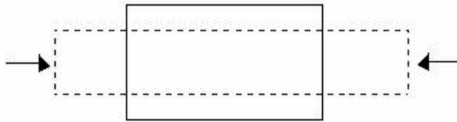
Figura 7. Deformación de un cuerpo y Razón de Poisson
