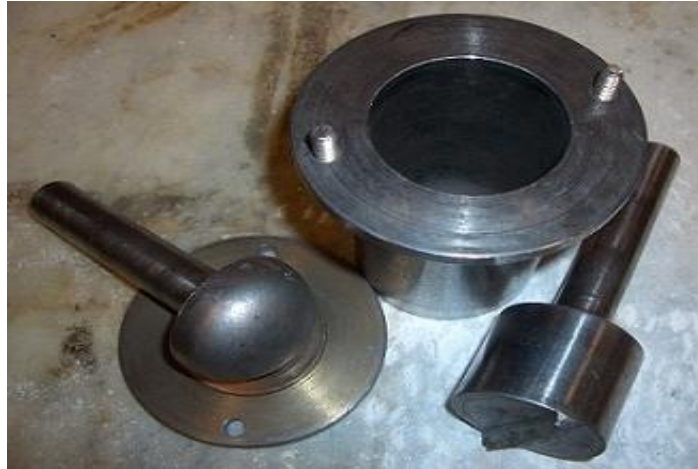
Figura 18. Cilindro para la trituración de la muestra de Shale .
