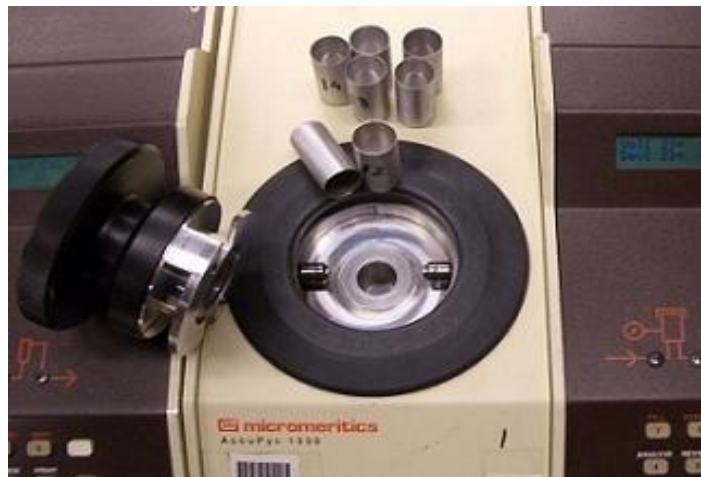
Figura 19. Picnómetro de Baja Presión – LPP (Low Pressure Pycnometer)
