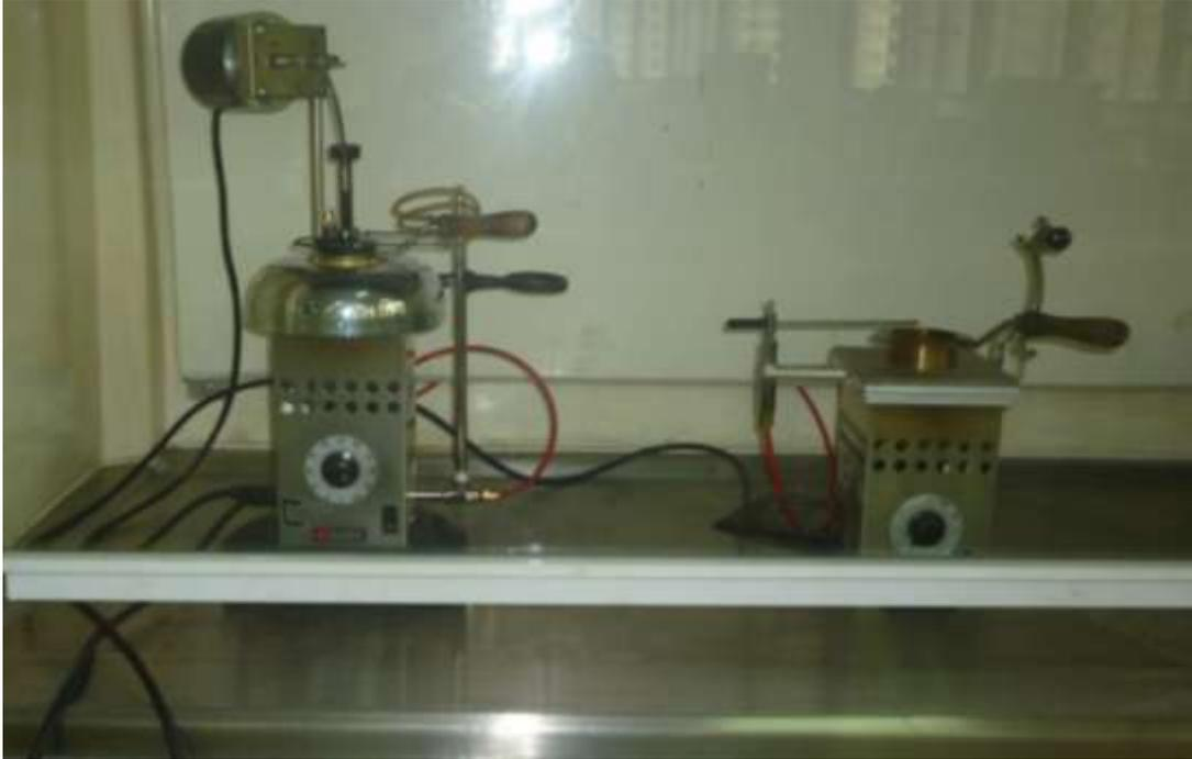
**Figura 4.1:** Equipos para determinar la temperatura de inflamación en el laboratorio de Crudos y Derivados de la Universidad Surcolombiana
