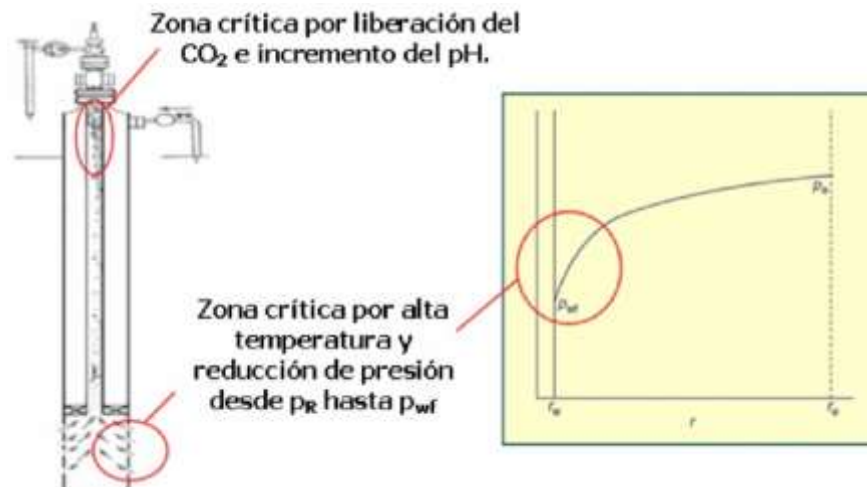
Figura 30. Variaciones de las condiciones termodinámicas que afectan la formación de escamas
