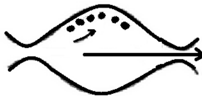
Figura 16 Vista lateral del mecanismo de depositación en la superficie del poro
