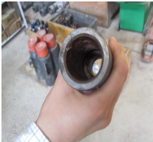
Figura 13. Subcoupling de 1" a 7/8". Instalaciones de TDA.
